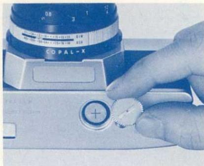
Le couvercle fileté du compartiment de la pile peut être facilement dévissé à l'aide d'une pièce de monnaie (24). On tournera, en sens inverse des aiguilles d'une montre. Mettre la pile en place, le plus vers soi (voir photo). La pile dure environ une année selon la fréquence de l'utilisation de l'appareil. Nous recommandons d'utiliser une pile EVEREADY S-76 ou éq., mais dans le cas d'une inutilisation prolongée, il est conseillé d'enlever la pile de son compartiment.
